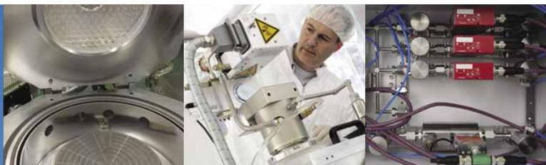
Платформа NEO 200A является самым современным пополнением в линейке систем плазменной обработки, озонения и зачистки пластин от компании Trymax Semiconductor Equipment. Это полностью автоматическая система с одной камерой, которую можно сочетать с любым из существующих технологических модулей Trymax для обработки подложек диаметром до 200 мм. Несмотря на компактный размер, установка NEO 200A работает с двумя кассетами одновременно.
